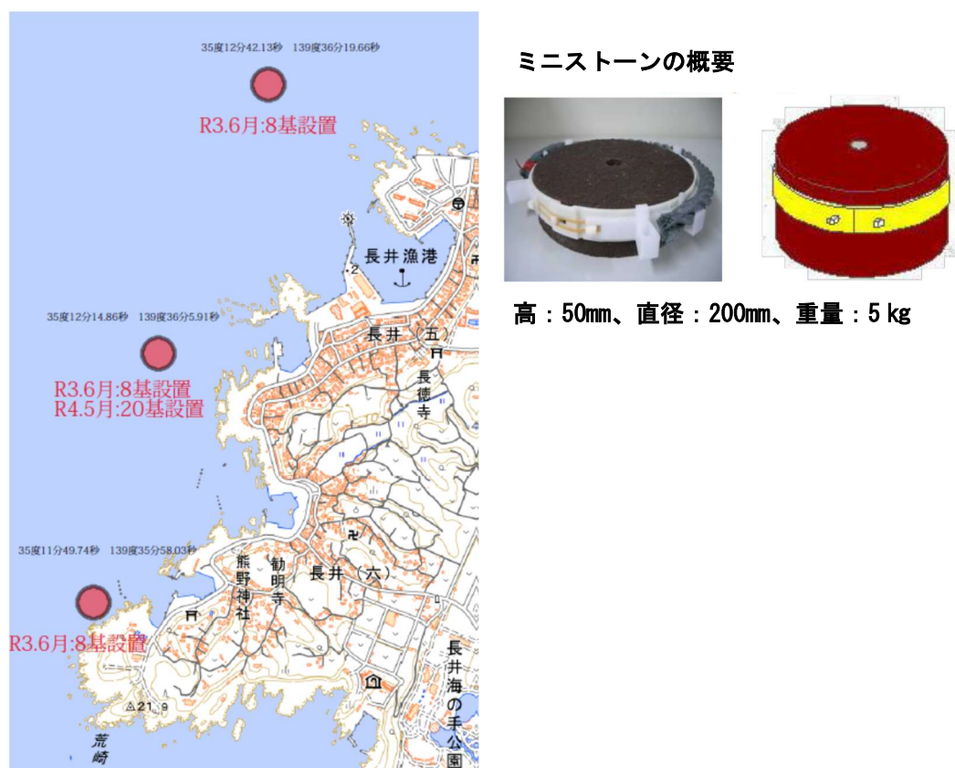
図 14 ミニストーン（藻礁ブロック）の設置位置
