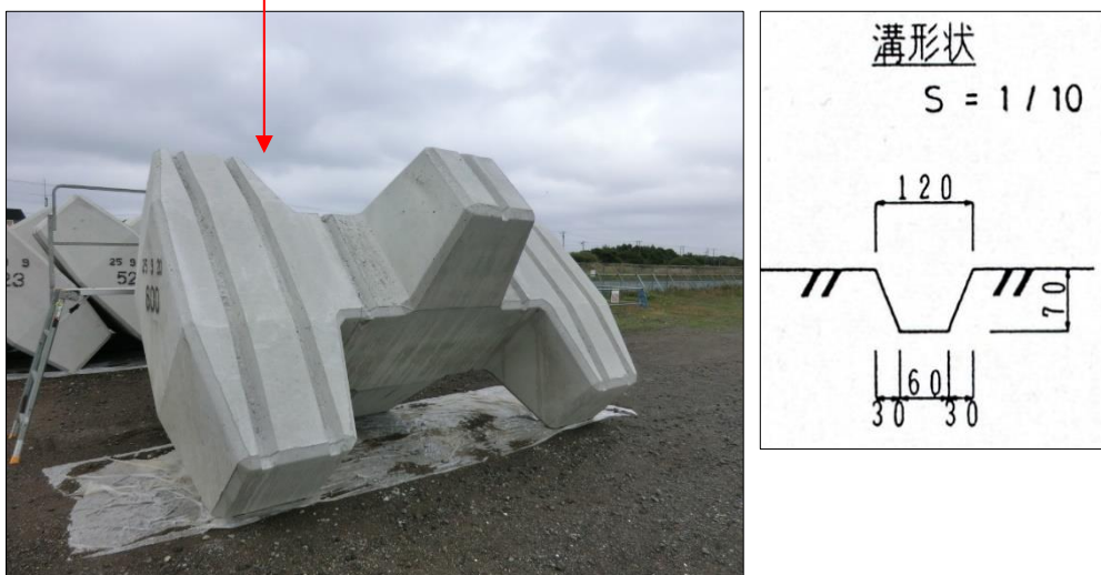
図 1-4 人工リーフを構成する水産協調型 (溝加工) コンクリートブロック (1 基目～4 基目)
