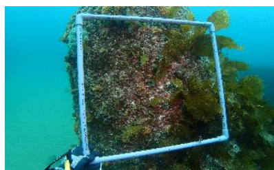
図-7 潜水による目視調査（測点 2:石炭灰重量モルタルブロック部） （左図は、浅所（D.L. -3.0m）（コドラート被度 95%） 右図は、深所（D.L. -10.0m）（コドラート被度 40%））
