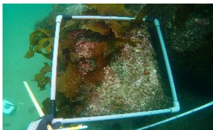
図-6 潜水による目視調査（測点 1:石炭灰重量モルタルブロック部） （深所（D.L. -10.0m）（コドラート被度 70%））
