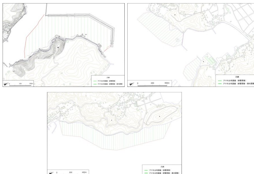
図 6 各干潟における音響測深機および潜水の調査側線
