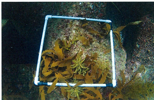
図-5 潜水による目視調査 (測点 1:石炭灰重量モルタルブロック部)
